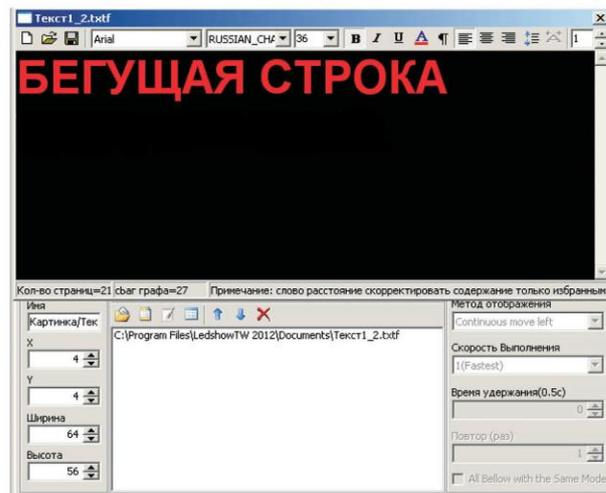
Нажимаем на кнопку "Создать текст" (5). Набираем нужный текст, выбираем нужный шрифт, его высоту, интервалы между буквами и строками. После закрываем окно, редактируем ширину и высоту, а также местоположение зоны (2-3). Затем выбираем нужный эффект и скорость(7). Для того чтобы текст был обычной бегущей строкой идущей справа налево выбираем эффект "Continuous move left".
