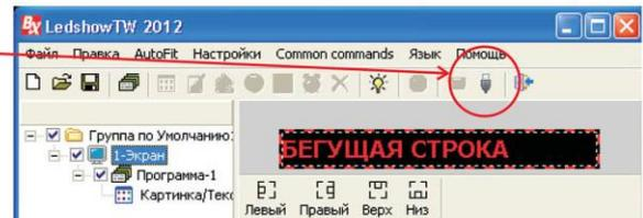
После загрузки данных на флешку снизу окна в информационном поле **появится надпись**. Затем закрываем окно. Вынимаем флешку, вставляем ее в табло. Ждем 3 сек и всё, вынимаем флешку. Информация уже на табло.
